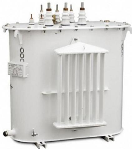
Трехфазный масляный трансформатор ТМТО-80/0,38-У1 отвечает за преобразование электрической энергии в составе трансформаторной подстанции КТПТО, которая используется для термической обработки бетона и грунта, непостоянного освещения в условиях умеренного климата, а также для питания инструмента от сети. Диапазон окружающей температуры воздуха - 45°C/+ 10°C.
