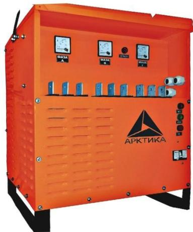
ТСДЗ – 63/0,38 УЗ; ТСДЗ – 80/0,38 УЗ предназначен для электропрогрева бетона и мерзлого грунта. Эффективность метода прогрева бетона высока и позволяет быстрее достигнуть необходимых прочностных характеристик. Так, скорость высыхания бетона при обычном способе строительства составляет примерно один месяц. В случае же электрического прогрева бетона он высыхает намного раньше — от одной до трех недель — все зависит в этом случае от температуры окружающей среды, от марки бетона и его плотности.
