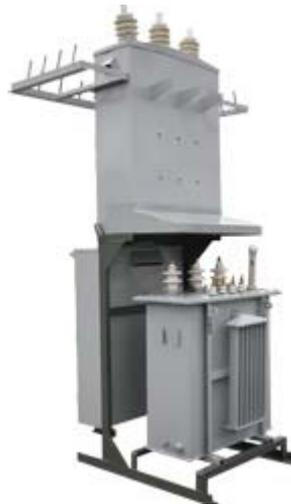
Мачтовые комплектные трансформаторные подстанции КТПМ - 100 применяются для приема электроэнергии от ЛЭП напряжением 6 или 10 кВ и частотой 3-фазного переменного тока 50 Гц для последующего распределения и передачи потребителям электроэнергии напряжением 0,4 кВ.
