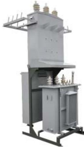
Мачтовая комплектная трансформаторная подстанция КТПМ-160 представляет собой трехфазный трансформатор, который предназначен для того чтобы принимать электроэнергию переменного тока и снабжать ею населенные пункты, промышленные комплексы и прочее. При этом энергия, поступающая в подстанцию имеет частоту 50 Гц и напряжение 10 или 6 кВ, которая на выходе преобразовывается в номинальное напряжение 0,4 кВ. Мачтовая подстанция имеет следующую комплектацию:
