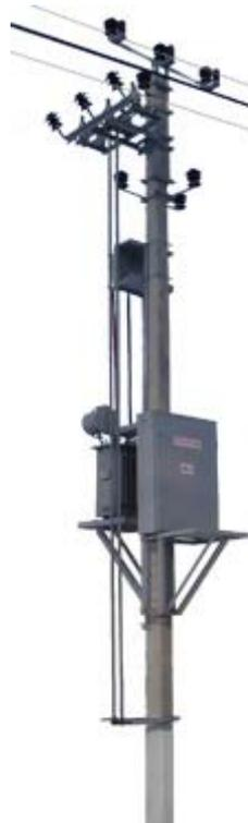
Комплектные трансформаторные подстанции столбового исполнения КТПС - 63 предназначены для приема со стороны ЛЭП электроэнергии напряжением 6 или 10 кВ и с частотой переменного 3-хфазного тока 50 Гц для последующей передачи электроэнергии напряжением 0,4 кВ потребителям.
